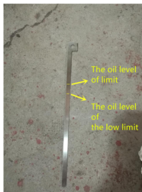
8. obr. (min. a max. hladina oleje)
